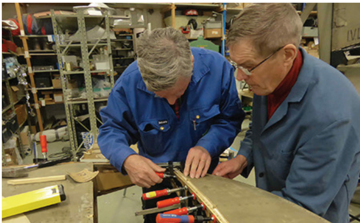
Ilmailumuseon Tiistai-kerholaisia korjaamassa Haukka-hävittäjän siipeä. Kuvassa vas. Leo Anttola ja Mikko Jaakkola. Kuva: Lassi Karivalo.
