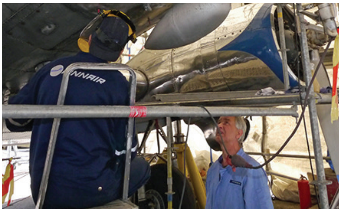
DC-3-lentokoneen alapinnan maalinpoisto käynnissä. Kuva: Reino Myllymäki.
